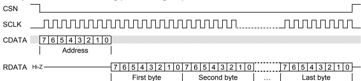
**Figure 4 C-BUS Data-Streaming Operation**
